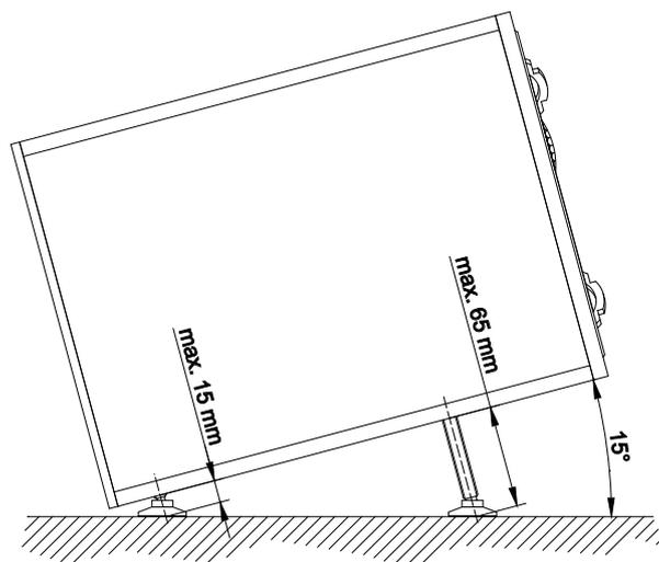
Der Centerlautsprecher darf nicht ohne die vormontierten höhenverstellbaren FüÙe betrieben werden, da sonst Luft aus den Gewindebohrungen austritt und dies die Wiedergabequalität beeinflusst.
